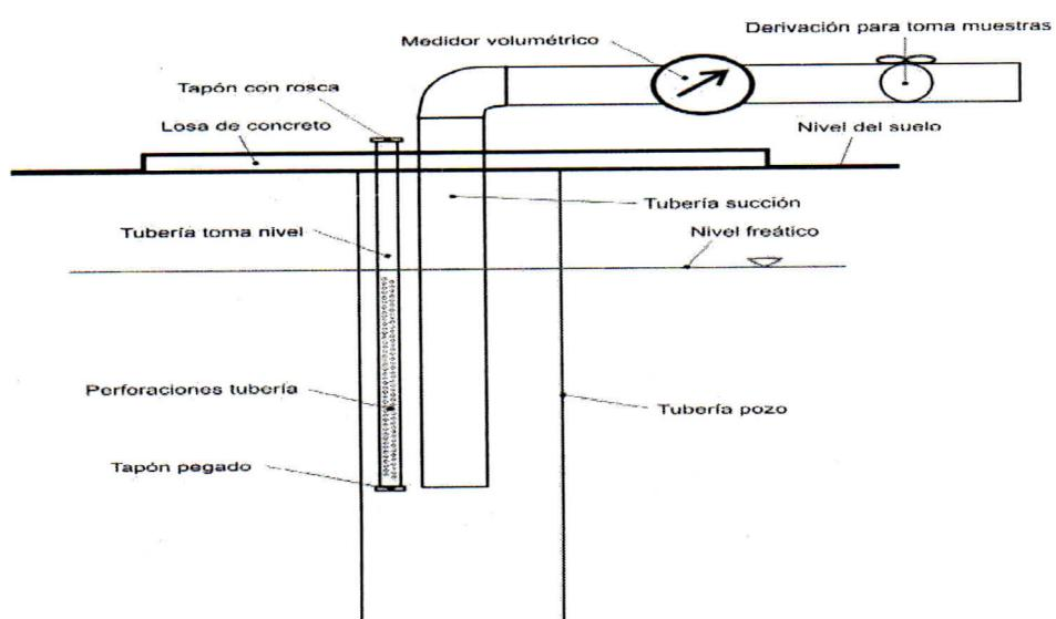
Figura 2. Instalación dispositivos de control al pozo
