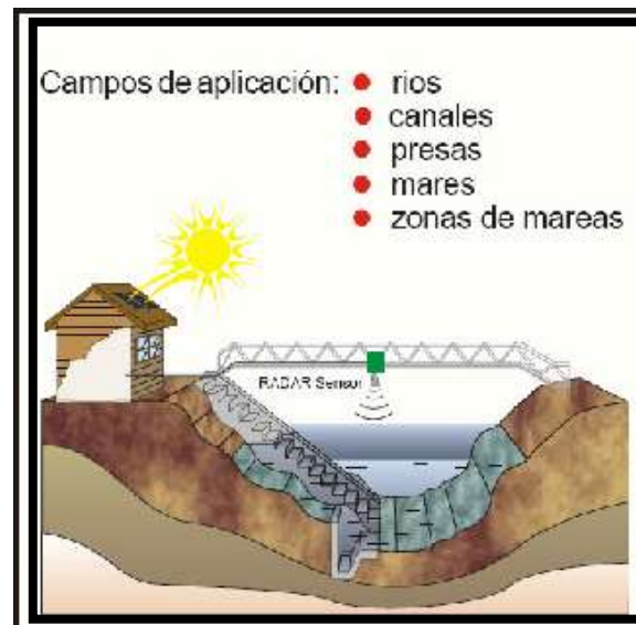
FORMA DE INSTALACIÓN DEL SENSOR
