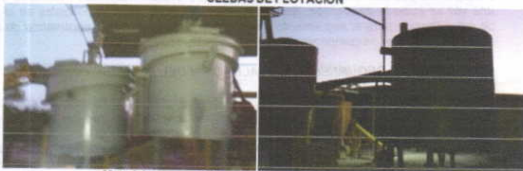
Material entra con 2/3 partes de agua y 1/3 mineral pulverizado
