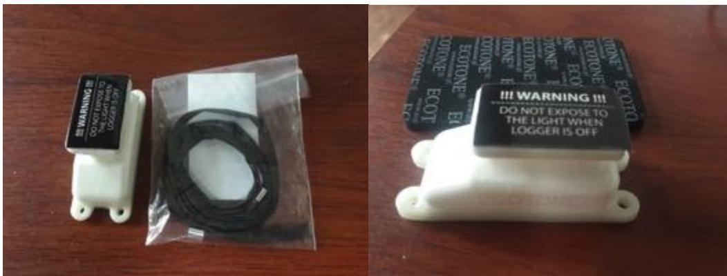
Figura 44. Transmisor ECOTONE tipo SULA, con alimentación solar y sistema GSM
