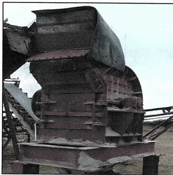
Figura 5. Trituradora secundaria con cono.
