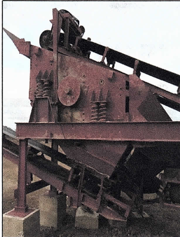
Figura 6. Zaranda vibratoria horizontal.
