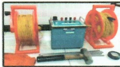
Imagen No 5: Resistivmetro usado en la toma de datos geoelectricos.
