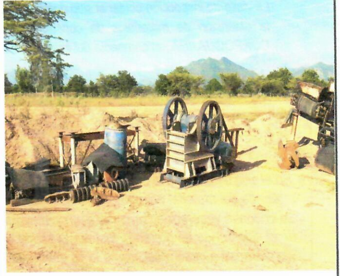
Imagen 1. Planta procesadora y maquinarias empleadas en la trituración de la materia prima para la obtención de materiales de construcción.
