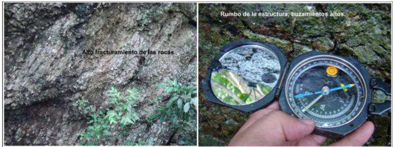
FOTO 17. Fracturamiento en rocas de la formación Hato nuevo.
