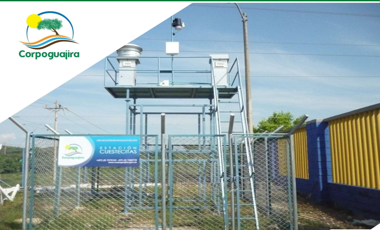
Fotografía: Estación de monitoreo de calidad del aire, Estación CUESTECITAS SEVCA CORPOGUAJIRA
