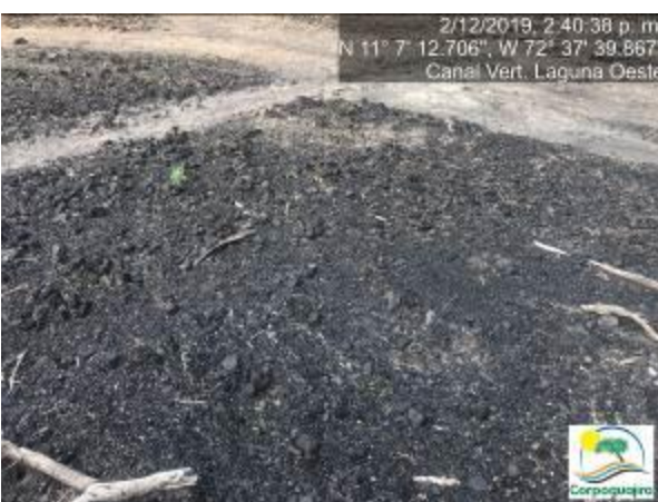
Fotografías No. 23 y 24. Mineral de carbón sedimentado en el canal de vertimiento de la Laguna Oeste. CARBONES DEL CERREJON LIMITED – CERREJON. COMPLEJO MINA. 02 de diciembre de 2019. (Fuente: Corpoguajira 2019).
