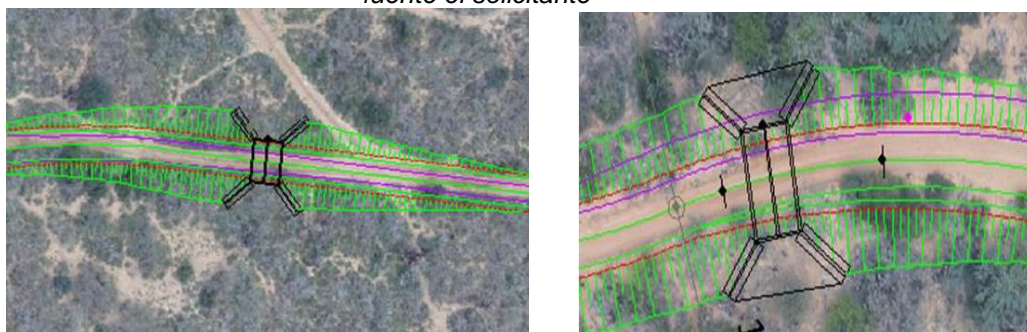
Grafica 8 y 9. Obra de drenaje transversal tipo marco rectangular (box Culvert) fuente el solicitante
