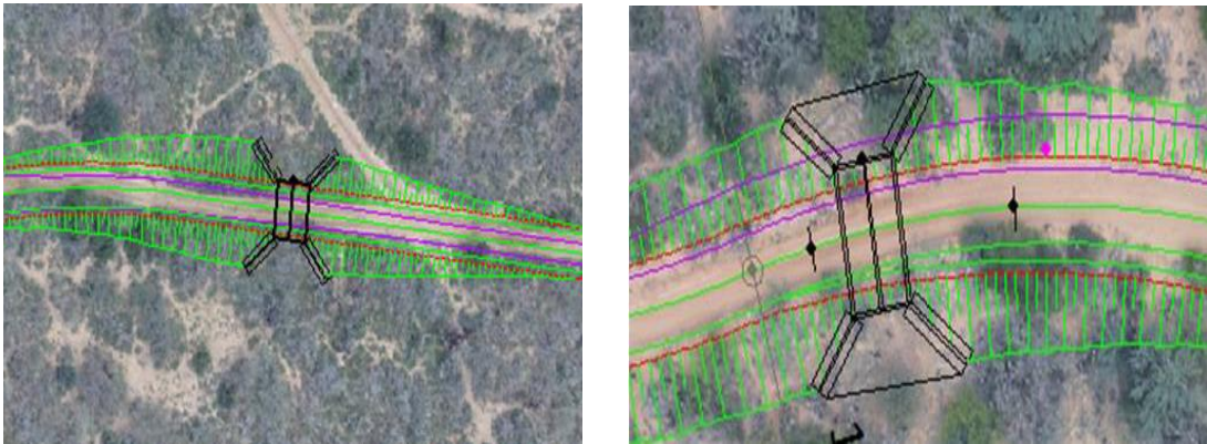
Grafica 8 y 9. Obra de drenaje transversal tipo marco rectangular (box Culvert), fuente el solicitante
