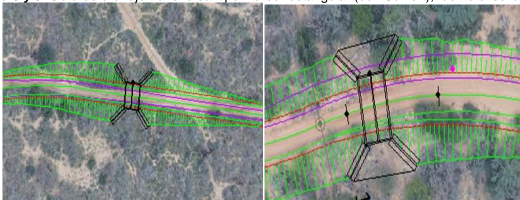
Figura 8 y 9. Obra de drenaje transversal tipo marco rectangular (box Culvert), fuente el solicitante
