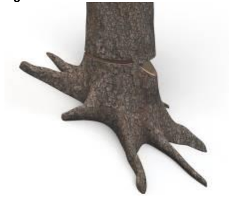
Figura 4. 3 Corte direccional inverso
