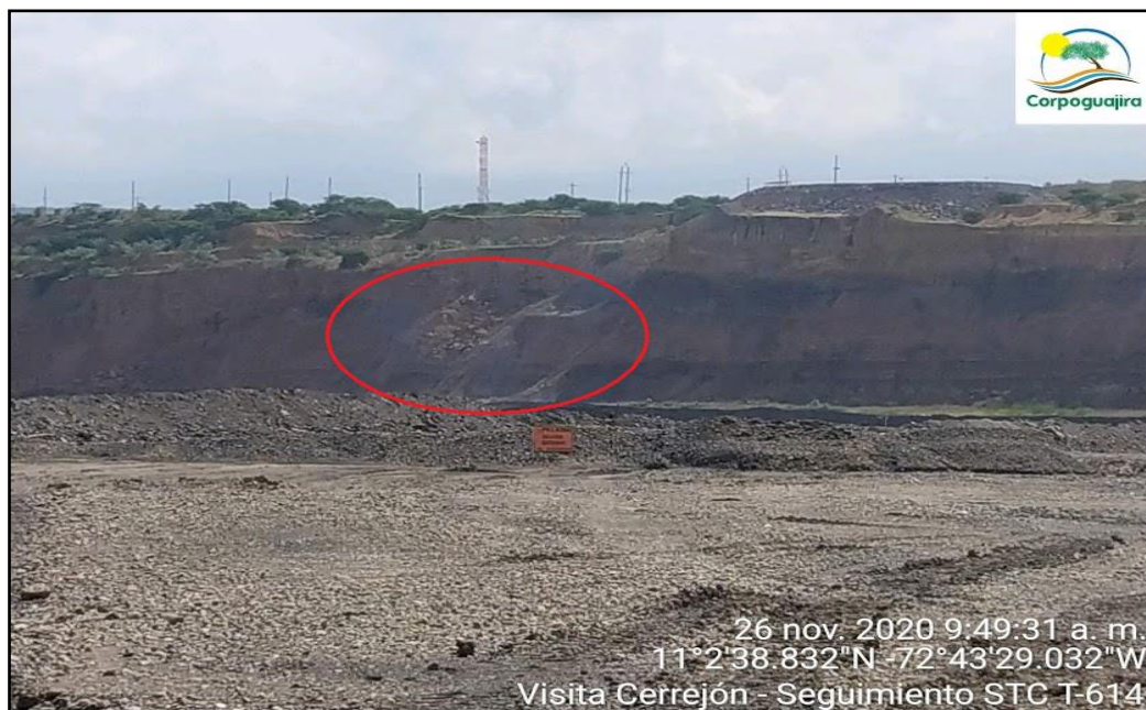
Figura 10. Incendio de manto de carbón en la parte sur del Fotwall del Tajo Patilla.
