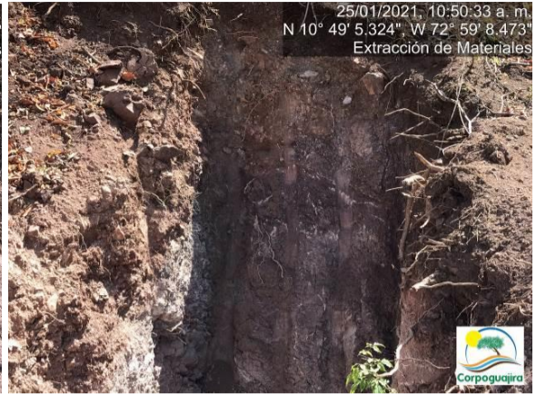
Fotografías No. 19 y 20. Apiques realizados con maquinaria para conocer los materiales a extraer. 25 de enero de 2021. (Fuente: CORPOGUAJIRA 2021).
