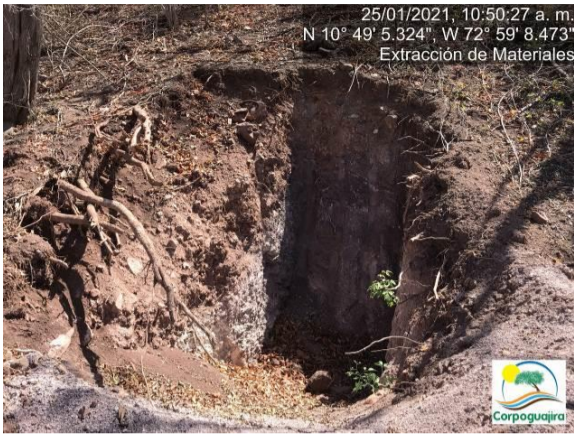
Fotografías No. 19 y 20. Apiques realizados con maquinaria para conocer los materiales a extraer. 25 de enero de 2021. (Fuente: CORPOGUAJIRA 2021).
