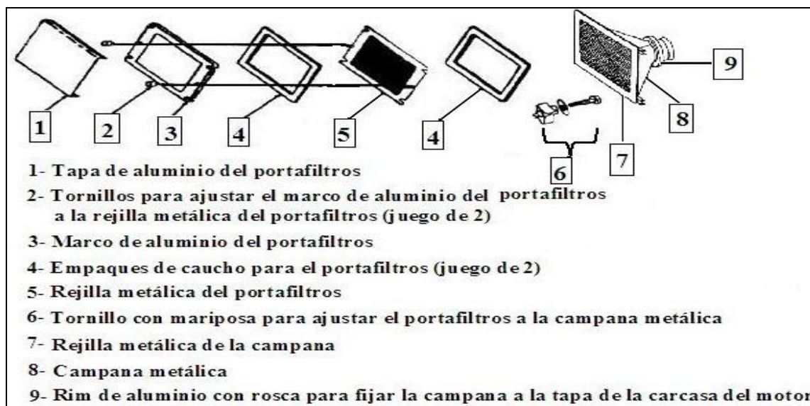
Figura 4. Partes de un portafiltros para equipo Hi Vol PM10. Fuente: Adaptado del Manual de Operaciones (Tisch).
