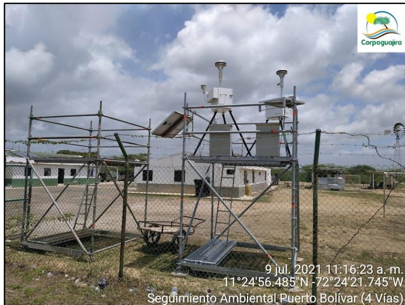
Figura 22. Estación de Monitoreo de Calidad del Aire Cuatro Vías.
