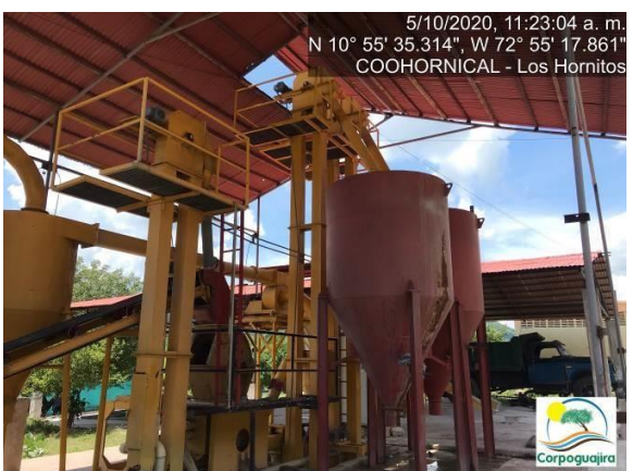
Fotografía No. 15 y 16. Pulverizador y humectador de minerales instalado en el centro minero. CENTRO MINERO COOHORNICAL. (Fuente: Corpoguajira 2020).
