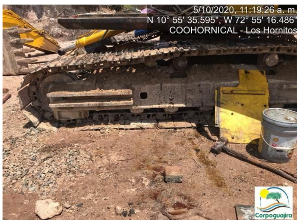
Fotografía No. 23 y 24. Contaminación del suelo por el vertimiento de aceites e hidrocarburos derivados de mantenimiento de maquinaria pesada. CENTRO MINERO COOHORNICAL. (Fuente: Corpoguajira 2020).
