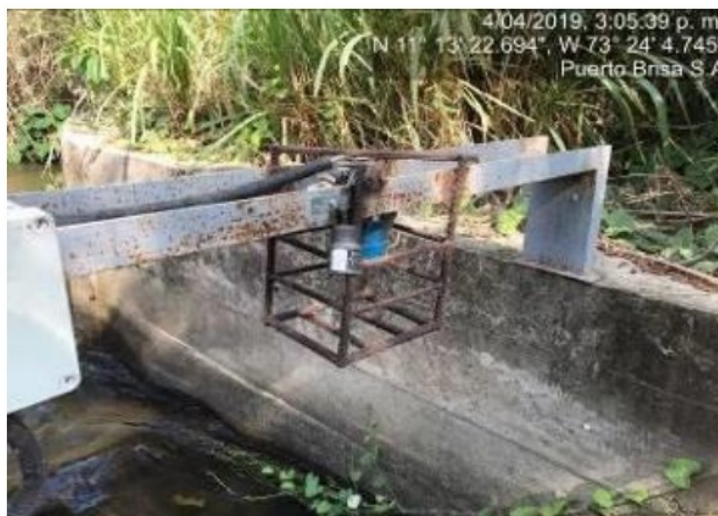
Fotografías No. 1. Canal La Chinita con Canaleta Parshall y Sensor de Flujo. Fuente: CORPOGUAJIRA 15/10/2019.
