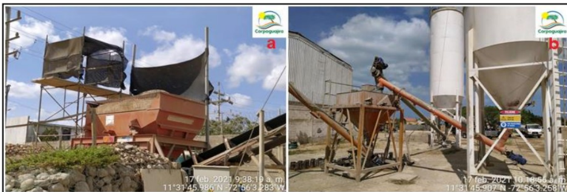
Figura 2. a) Tolva alimentadora y banda b) Silos y sistema de transporte de cemento al shut. Fuente: CORPOGUAJIRA, 2021.
