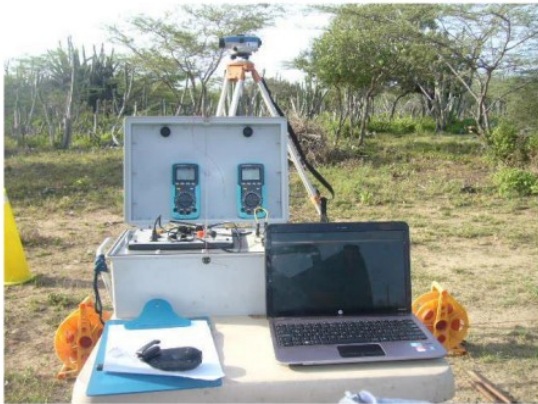
Foto 7. Equipo para prospecciones geoelectricas en corriente continua, Earth Resistivity Instruments. Tomado del documento del peticionario.
