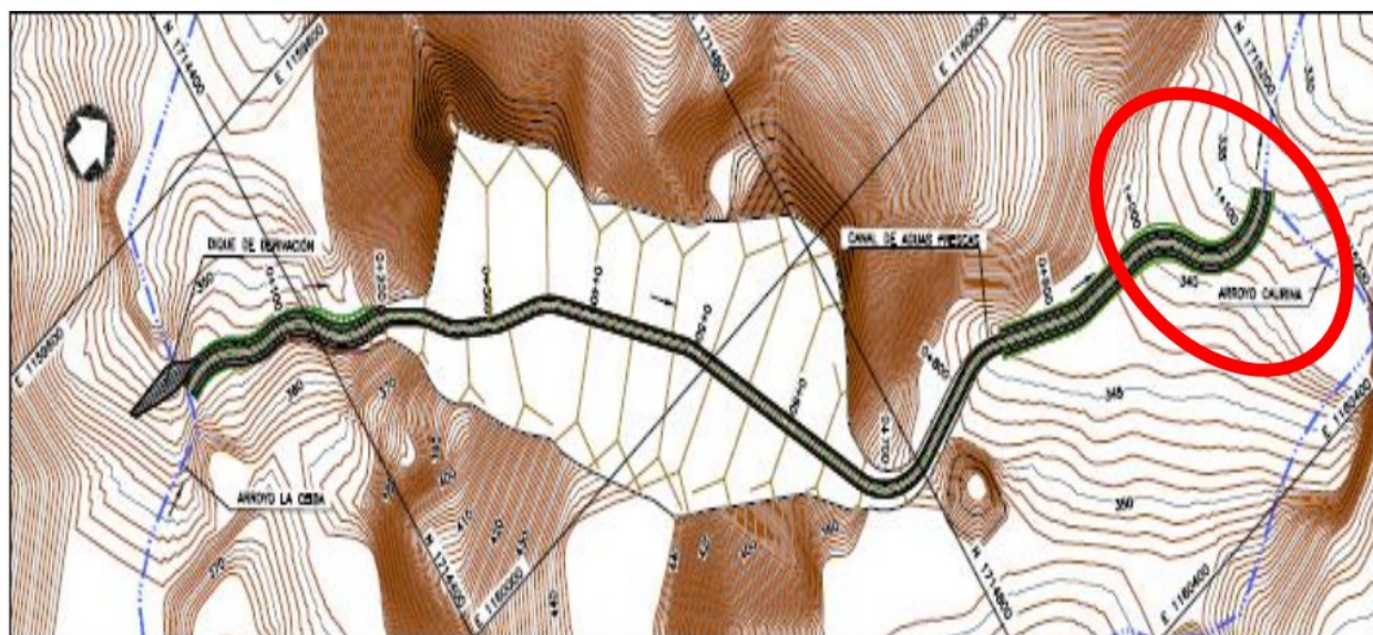
Figura 10. Esquema del canal completo de reorientación del arroyo la Ceiba hacia el arroyo Caurina
