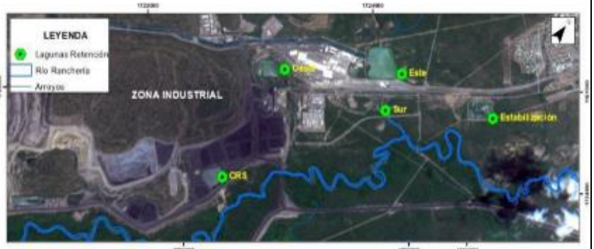
Imagen 5. Lagunas de retención y sumideros de tajo -Zona Industrial (Fuente: Cerrejón 2021)
