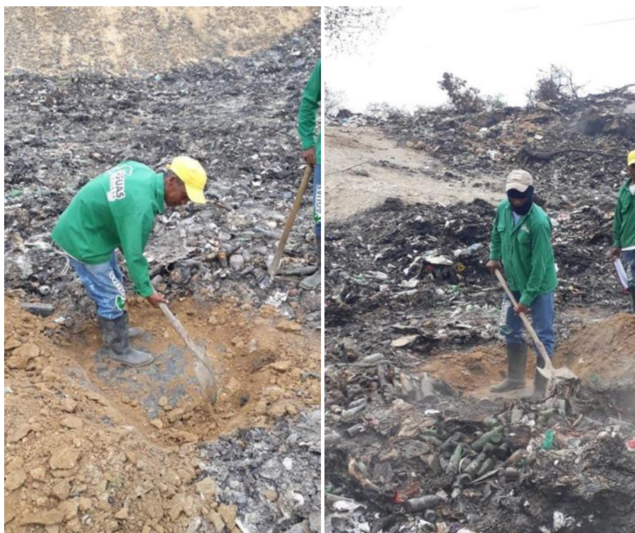
Fotos 3 y 4. Calicatas en la celda del relleno sanitario de Dibulla. Fecha: 14 de febrero 2022. Fuente: ALCALDÍA DE DIBULLA
