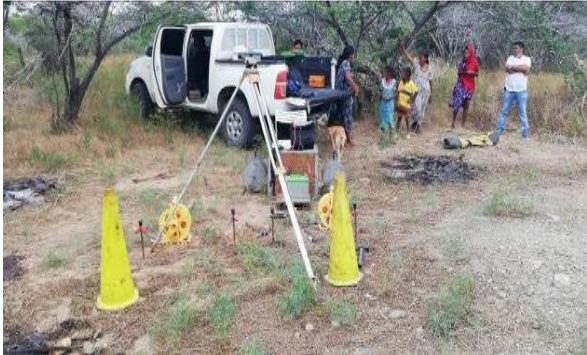
Fotografía 8: Imagen del equipo utilizado para el SEV fuente estudio Geoelectrico
