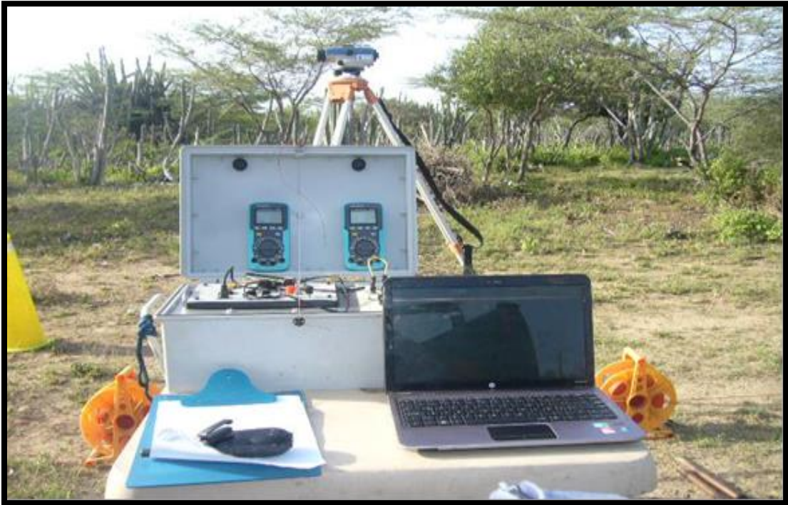
Fotografía 5: Imagen del equipo utilizado para el SEV fuente estudio Geoelectrico
