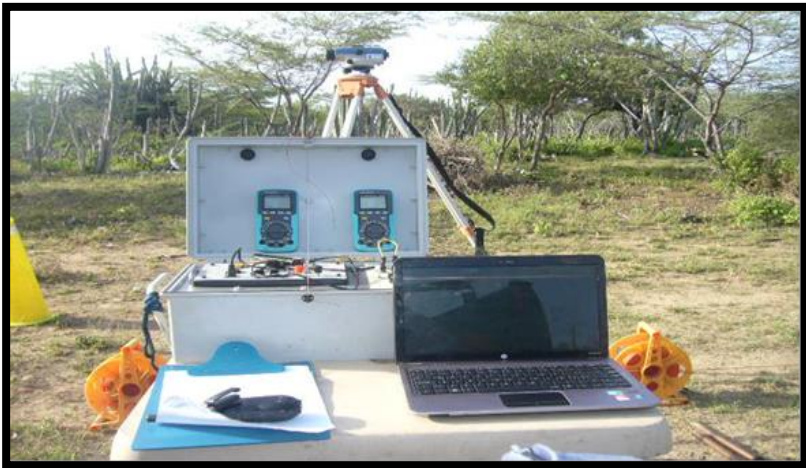
Fotografía 7: Imagen del equipo utilizado para el SEV fuente estudio Geoeléctrico
