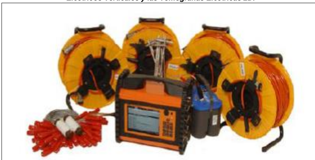
Figura 5. Equipo de resistividad TERRAMETER LS empleado para la ejecución de los Sondeos Eléctricos Verticales y las Tomografías Eléctricas 2D.
