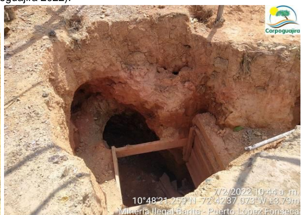
Fotografía No. 03 y 04. Creación de nuevos túnel subterráneo para la explotación de mineral Barita. 07 de febrero de 2022. (Fuente: Corpoguajira 2022).
