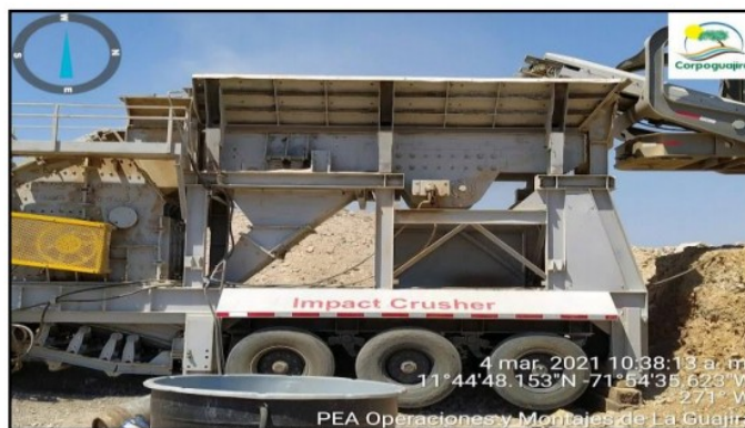
Figura 11. Trituradora primaria y alimentador del impactor.
