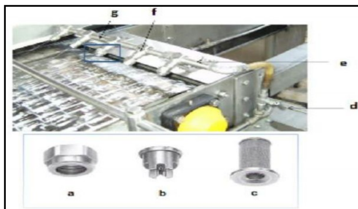
Figura 8. Componentes del sistema de flautas.
