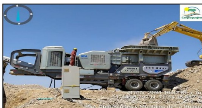
Figura 10. Tolva de alimentación y trituradora primaria.
