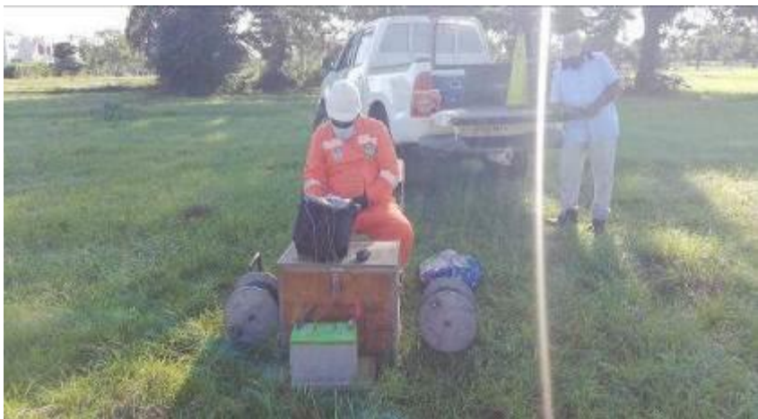
Fotografía 8: Imagen del equipo utilizado para el SEV fuente estudio Geoelectrico (Fuente: Documento solicitud COMFAGUAJIRA 2021).
