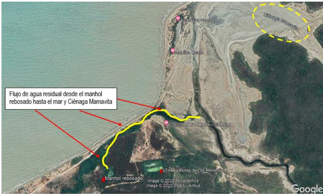
Imagen satelital No 1. Vertimiento de aguas residuales generadas en el corregimiento de La Punta de Los Remedios desde un manhol hacia el suelo, el mar y la Ciénaga Mamavita, sin tratamiento previo y permiso de vertimientos.
