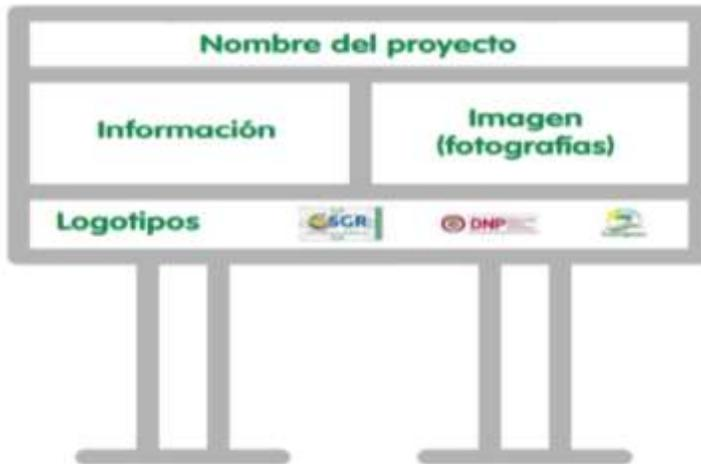
Las vallas deben tener dimensiones de 3m x 2.0m, con una estructura de 2 cerchas verticales, paneles en láminas galvanizadas, banner adhesivo impreso a full color en HD y tintas eco solventes y fondo color blanco.
